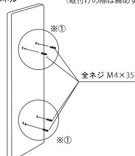
(取付けの際は締めすぎにご注意ください。工具を使用せず手締めにて行って下さい。)
