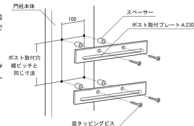
4. ポストの取付穴とプレートの長穴の位置を合わせ、付属のトラスネジ、ワッシャー、スプリングワッシャー、ナットを使用して、ポストとプレートを仮固定してください。このとき、ポストの位置が門柱の中心になるようにスライドさせてから本締めしてください。
