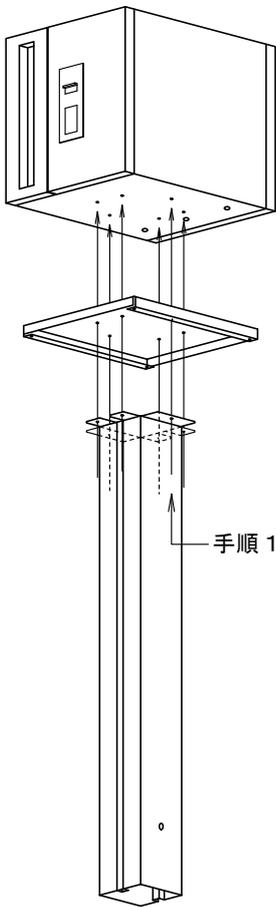
手順1：M4 トラスネジにスプリングワッシャー、ワッシャーをさし、スタンド上部の穴へ下から台座ごとダブルボックスポストにしっかり固定してください。
