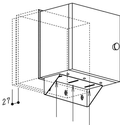
手順4：ダブルボックスポストの前面が壁から27mm出るように埋込補助プレートとダブルボックスポスト本体底面をネジで固定して、開口部に納めます。
