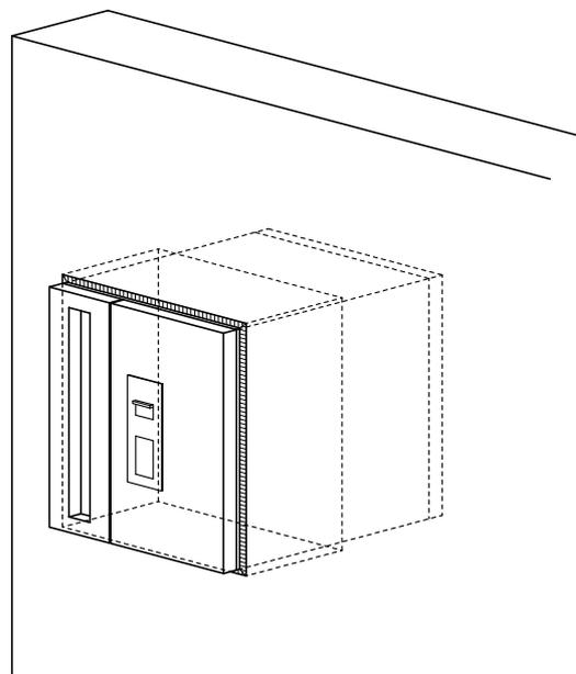
手順6：壁とダブルボックスポスト本体のすき間にモルタルを充填し、しっかりとダブルボックスポストを固定してください。モルタル乾燥後、シーリング材で壁の防水処理を行ってください。
