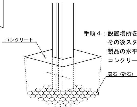
手順4：設置場所を掘削し、栗石（砕石）をGL：300mmで敷き固めてください。その後スタンドが倒れない様にしっかりと垂直に固定し、製品の水平垂直を確認後、コンクリートを流し込みます。コンクリートが硬化すれば全て取付は完了です。
