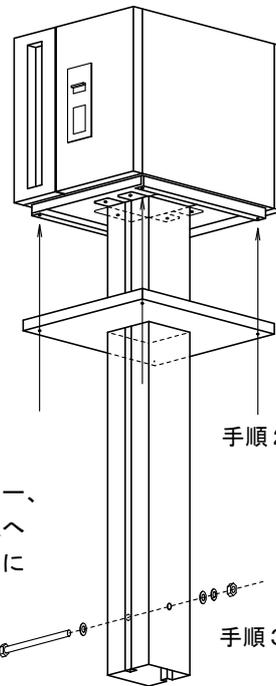
手順2：スタンド下部から化粧台座パネルをさし、上部へスライドしてM4 スリムヘッドネジで台座に固定してください。
