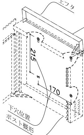
**⚠️** ポストの脱落防止のため必ず取付位置に下地があることを確認してください。
