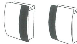
本体前扉のネジを4箇所外し、180度回転させラインの左右変更できます。
