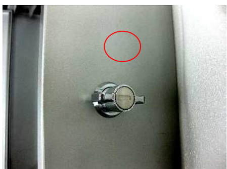
締付け時注意 締付け時 まっすぐなる位置で締めてください。
