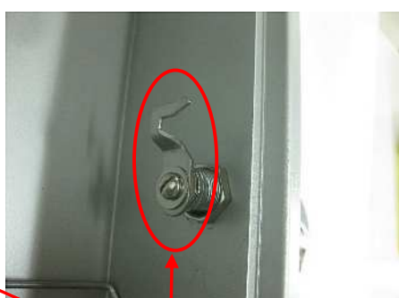
締付けた状態 シリンダーが縦で引っかかり金物も縦・横で横になり引っかかる状態です。
