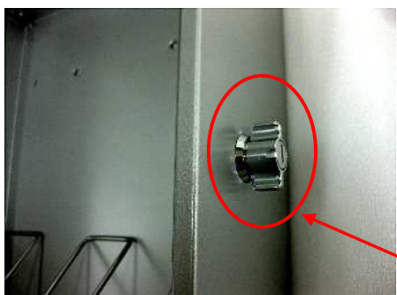
締付けた状態 シリンダーが縦で引っかかり金物も縦・横で横になり引っかかる状態です。
