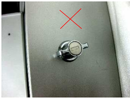
締付け時注意 締付け時 まっすぐなる位置で締めてください。
