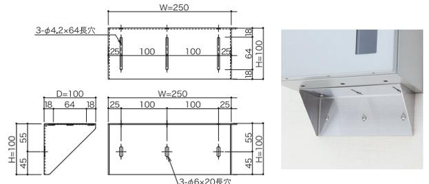
※壁埋込で取付けの際、しっかり固定できない場合にご使用ください。(適応壁厚:100~165)
